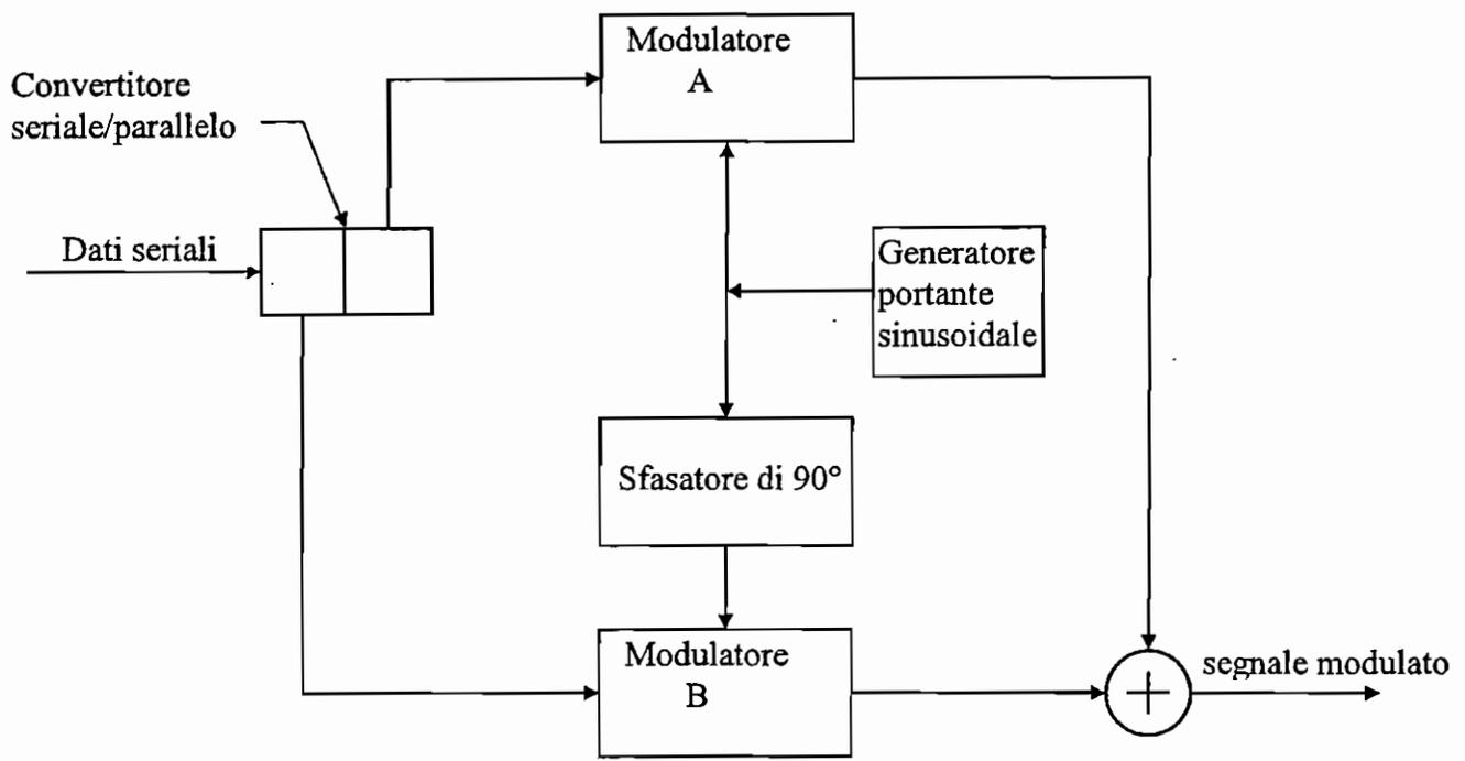
Tanto il modulatore A quanto il B realizzano una modulazione di tipo 2-PSK, la frequenza di portante è di 1800 Hz, all'ingresso del dispositivo i dati seriali giungono alla velocità di 2400 bps.
